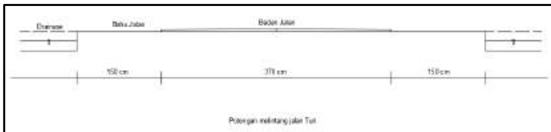
Gambar 1.7 Potongan Melintang Jalan Turi
